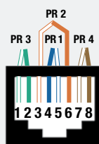
EIA/TIA568A WIRING
